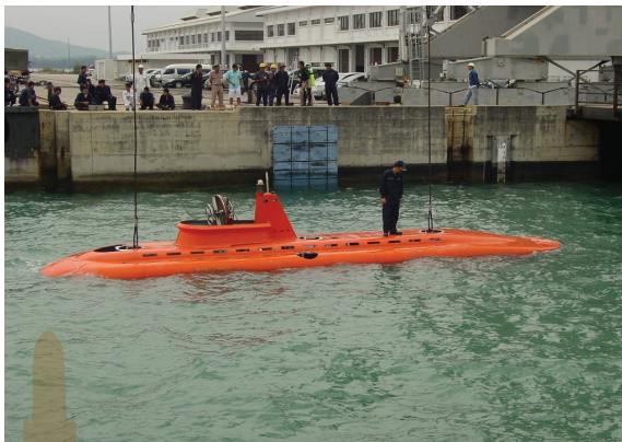
รูปที่ 4 แสดงระดับน้ำก่อนสูบน้ำเข้าถังอับเฉา
