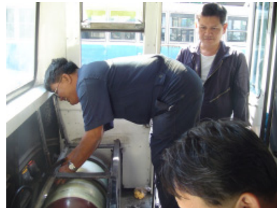
รูปที่ 24 ติดตั้งถังก๊าซธรรมชาติ (NGV)
