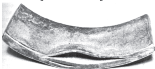
รูปที่ 7 Hydrogen blister in a carbon steel plate removed from a petroleum process stream (ที่มาของภาพ: Corrosion Engineering, 3 rd ed., หน้า 143)
