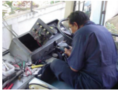
รูปที่ 23 ติดตั้งระบบควบคุมการจ่ายก๊าซธรรมชาติ (NGV)
