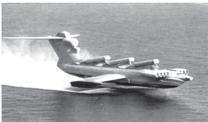
ยานบินเบาอากาศ Lun Ekranoplan มีการติดตั้ง Missile Launchers บนตัวยาน
