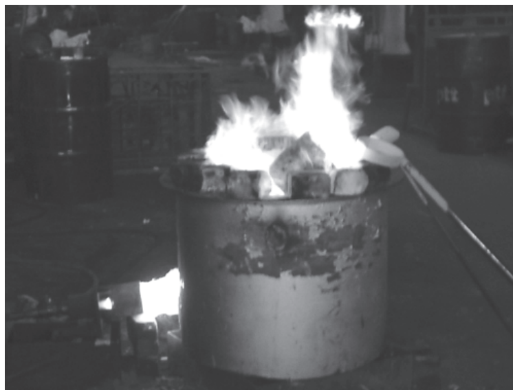
รูปที่ 5 ก. การบรรจุวัตถุดิบและหลอมบรอนซ์
