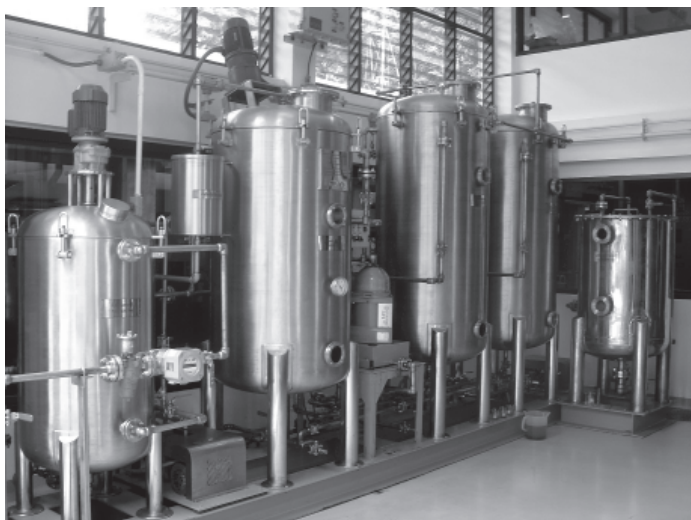
ระบบผลิตไบโอดีเซลโดยใช้น้ำมันพืชใช้แล้วเป็นวัตถุดิบ ณ โครงการสวนพระองค์ สวนจิตรลดา
