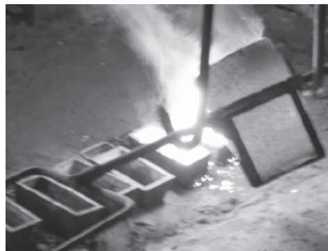
รูปที่ 7 การเตรียมแท่งโลหะนิกเกิลอลูมิเนียมบรอนซ์สำหรับการหล่อใบจักร
