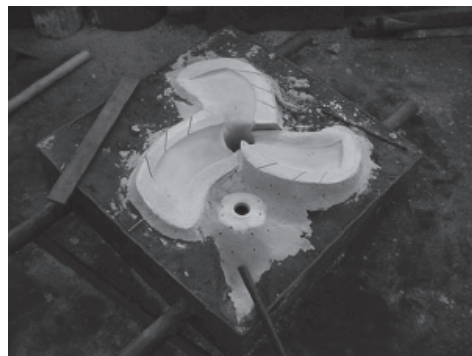
(b) แบบทราย CO 2 สำหรับทดลองหล่อใบจักรรูปที่ 8 แบบจำลองและแบบหล่อสำหรับการทดลองหล่อนิกเกิลอลูมิเนียมบรอนซ์
