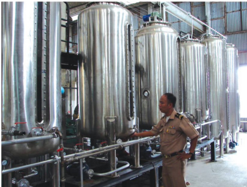
รูปที่ 1 ระบบผลิตไบโอดีเซลแบบกะ (Batch Process) ขนาด 6,000 ลิตร/วัน ของกรมอุทการเรือ
