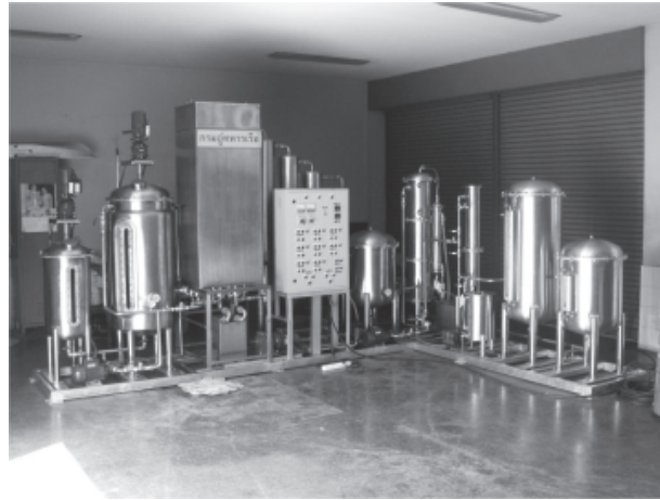
รูปที่ 3 ระบบผลิตไบโอดีเซลต่อเนื่อง (Continuous Process) ขนาด 2,000 ลิตร/วัน แบบไร้น้ำ ของกรมอุทกหารเรือ
