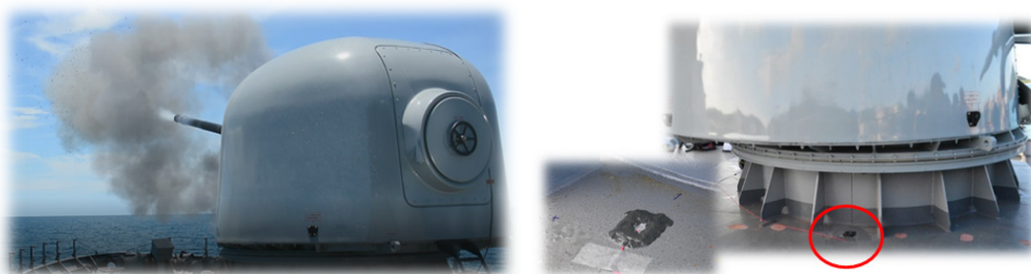
รูปที่ 14 แสดงตัวอย่างตำแหน่งการติดตั้งอุปกรณ์วัดความเครียด (Strain Gauge) ที่บริเวณฐานแท่นปืนหัวเรือขนาด 76/62 มิลลิเมตร OTO Melara (Refurbished)
