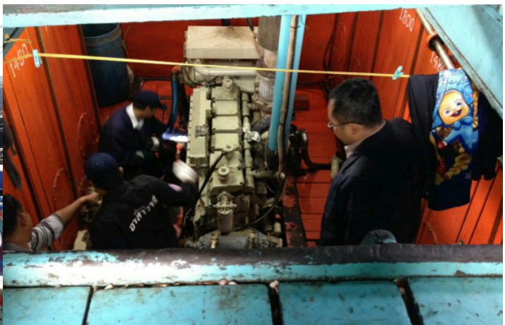
เจ้าหน้าที่ตรวจสอบสภาพเรือประมงกำลังตรวจสอบ ตราอักษรและขนาดกำลังของเครื่องยนต์เรือ
