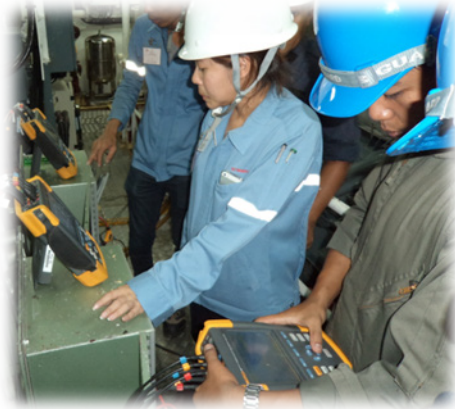
รูปที่ 15 แสดงการทดสอบทดลองเครื่องแปลงความถี่โดยใช้เครื่องวัดพลังงานไฟฟ้า (Power Quality Analyzer)
