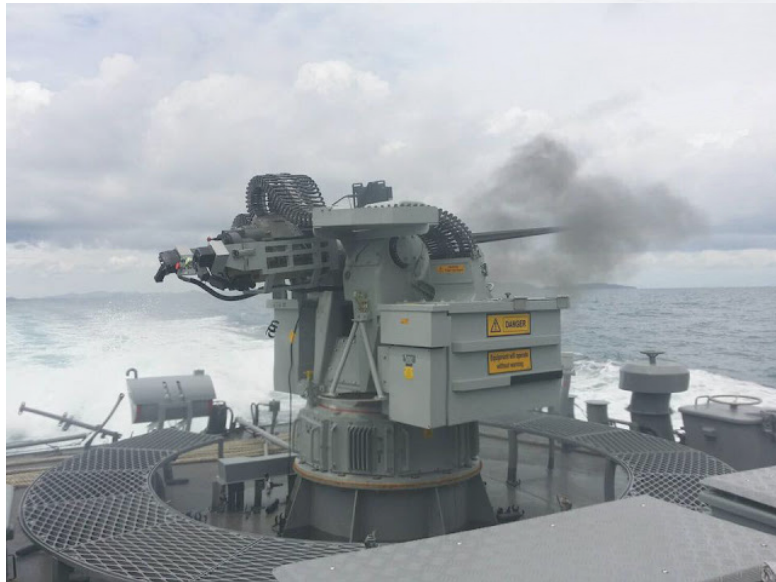
ภาพที่ 8 การทดสอบการยิงปืน 30 mm. MSI (ปืนท้าย)
