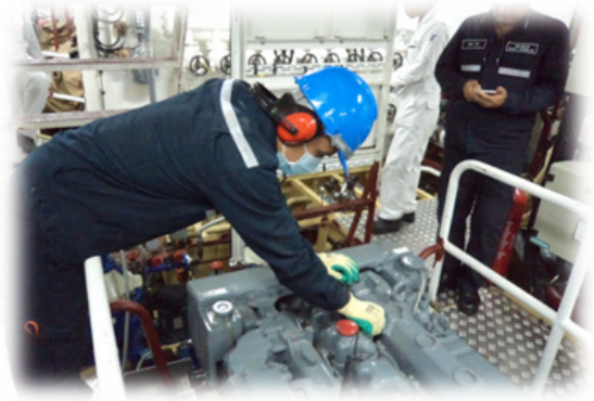
รูปที่ 12 แสดงการตรวจวัดการสั่นสะเทือนของระบบขับเคลื่อนที่บริเวณเครื่องจักรใหญ่โดยใช้เครื่องวัดความสั่นสะเทือน (Vibration Analyzer)
