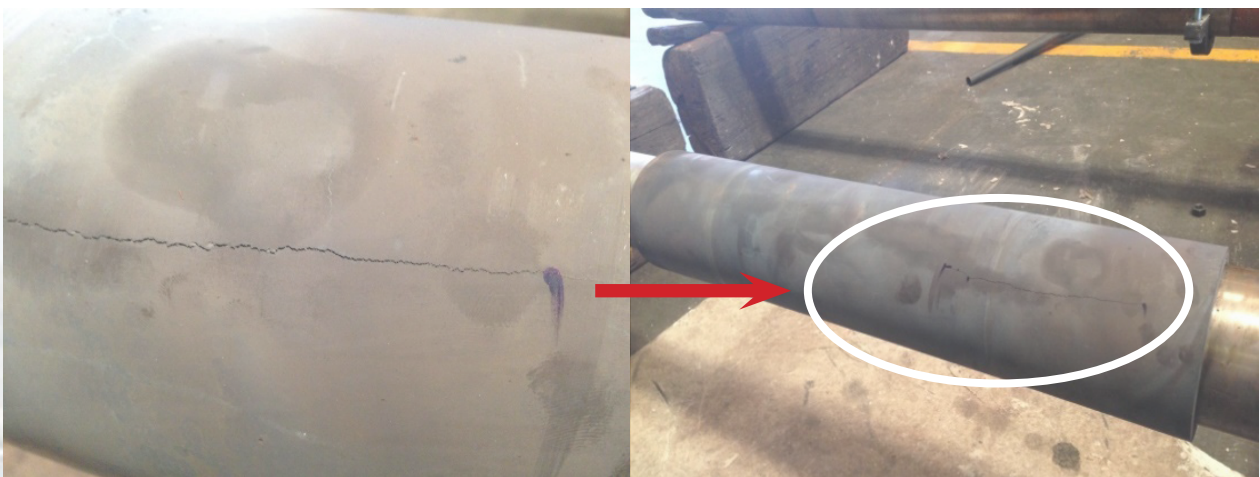
รูปที่ 1 แสดงการแตกร้าวของครอบงอกทองเหลืองหลังปล่อยให้เย็นตัวในอากาศ
