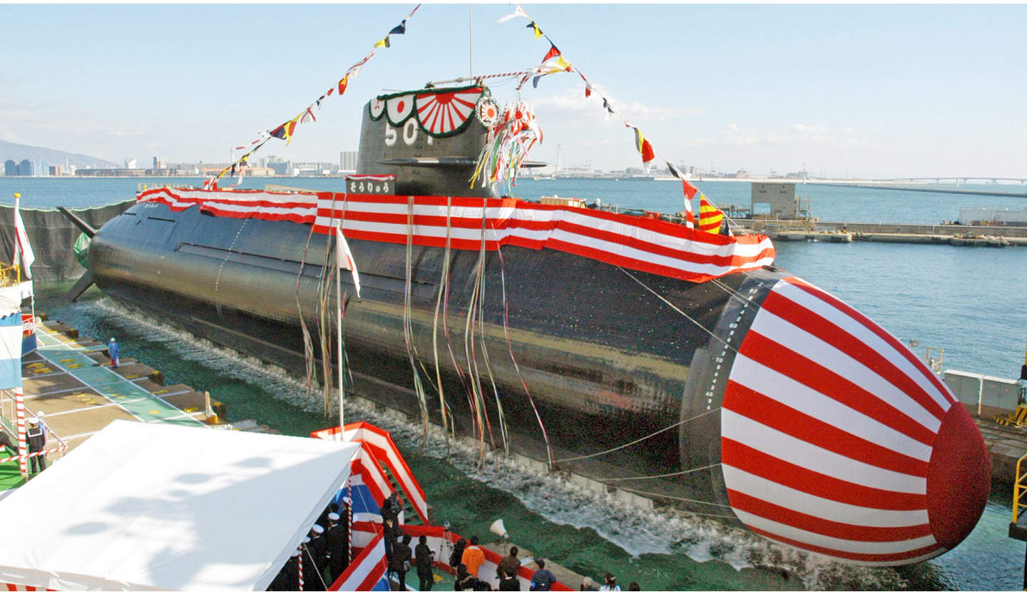
เรือดำน้ำชั้น Soryu ชื่อ Taigei ของประเทศญี่ปุ่น เรือดำน้ำลำแรก ของโลกที่ปิดเผยว่าใช้แบตเตอรี่ลิเธียมไอออน
