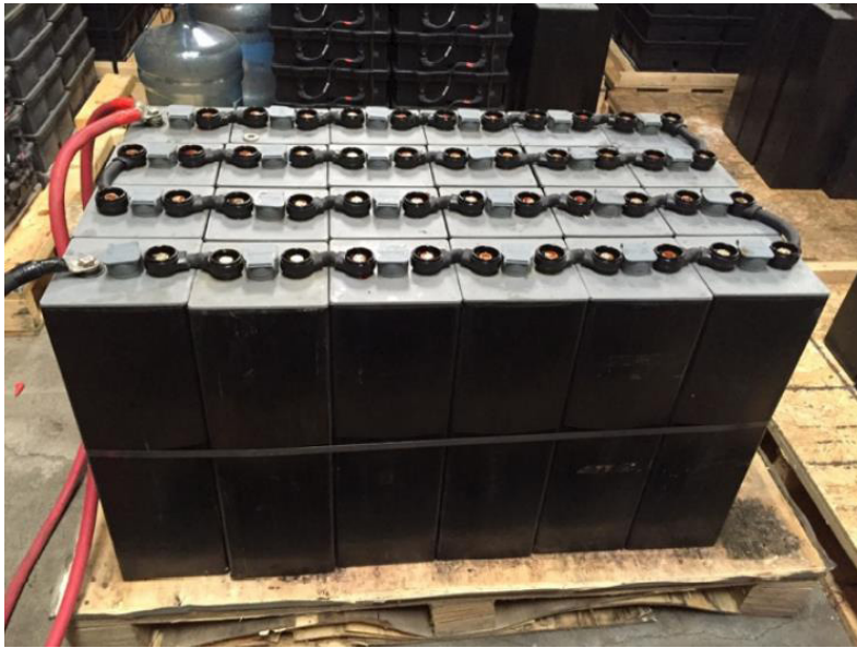
ภาพแสดงแบตเตอรี่เรือดำน้ำตราอักษร Hawker สำหรับกองทัพเรือสหรัฐ ฯ
