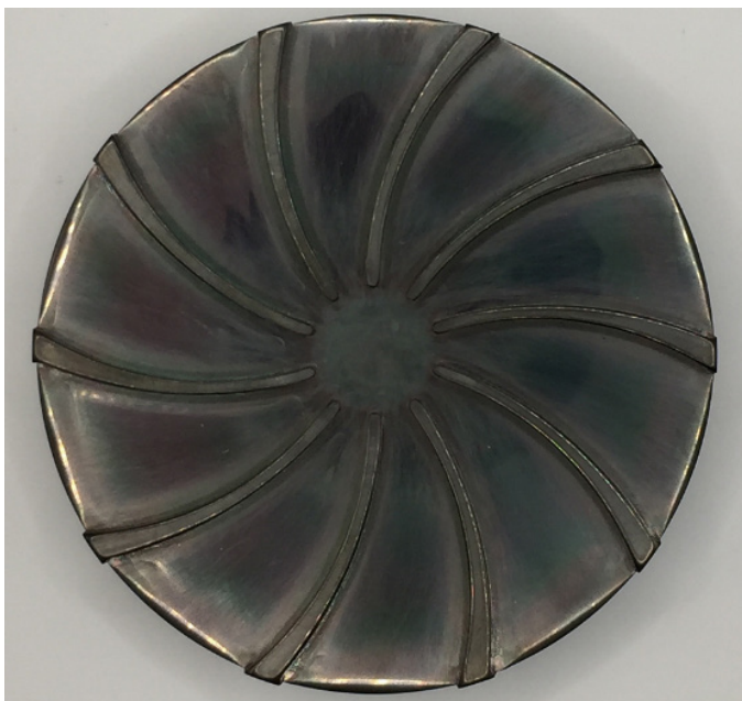
ภาพที่ 8 ภาพถ่ายใบพัดปั้มน้ำหอยโข่งที่ถูกเคลือบฟิล์ม DLC ด้วยเทคนิค hybrid RF-PECVD/MS
