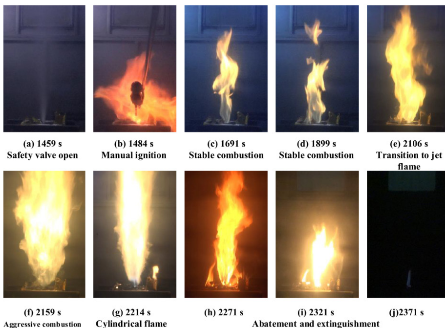
ภาพ รูปแบบการติดไฟ และการระเบิดของ แบตเตอรี่ลิเธียม ใน กรณีที่ใช้งานในความ ร้อนสูง [10]
