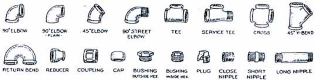
รูป 15.1 ข้อต่อท่อแบบมีเกลียว (Screwed Fittings)
