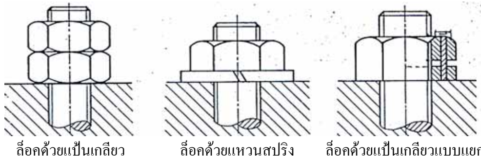
รูป 13.51 อุปกรณ์ล็อกโดยอาศัยความเสียดทาน
