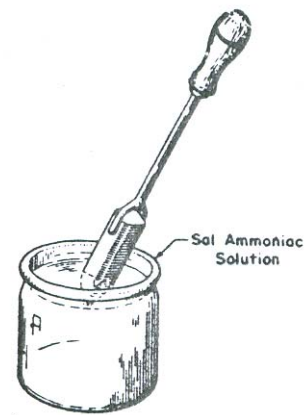
รูปที่ 8.45 การทำความสะอาดหัวแร้ง ด้วยสารละลาย Sal Ammoniac
