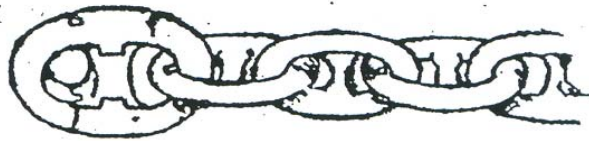
รูป ๑๓ โซ่สมอเหล็กกล้าตีเหนียวชนิดสเกลลูกโซ่
