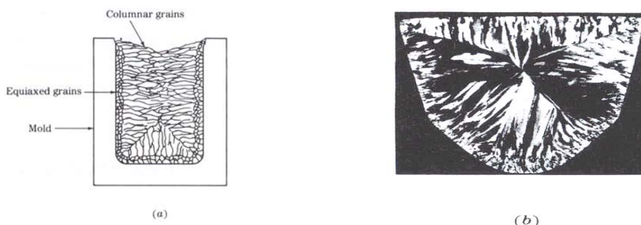
รูปที่ 3.1 (a) แสดงโครงสร้างของเกรนของโลหะที่แข็งตัวในแม่แบบที่เย็น
