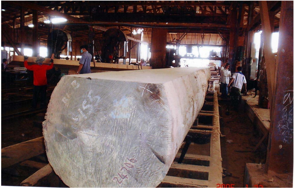
ซุงที่ได้รับการเปิดหลังหมุและบนรถเลื่อยซุง
