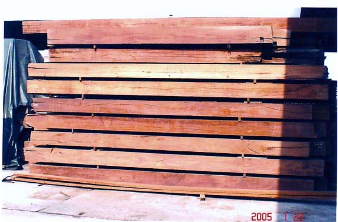
รูปแสดง การใช้ไม้รองหรือคั่น เพื่อให้มีอากาศถ่ายเทและป้องกันการผุกร่อนจากเชื้อรา
