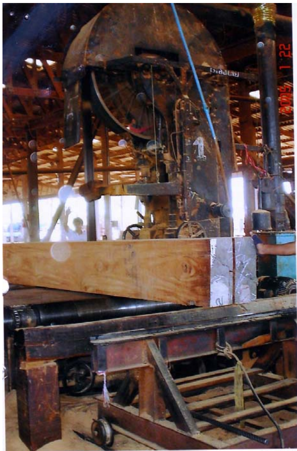
การแปรรูปไม้ซุงเป็นไม้ ใช้งานขนาดใหญ่บนโต๊ะ ขอยใหญ่
