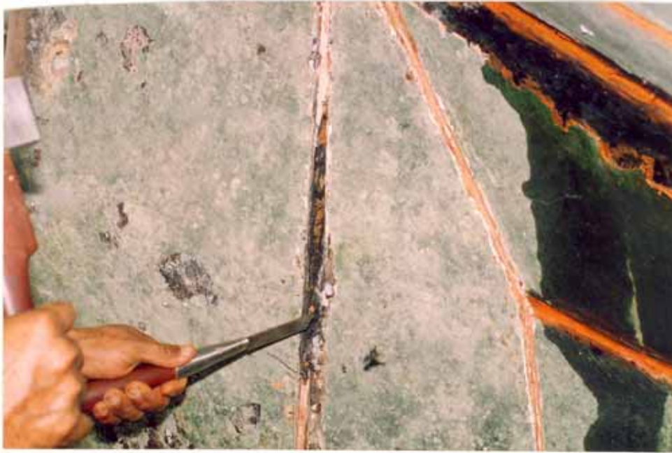
รูปที่ 50 แสดงการตรวจหมันด้วยสั้วตอก ส่วนที่เนาเป็นสีดำให้ลั้งออกด้วยสั้วตอก
