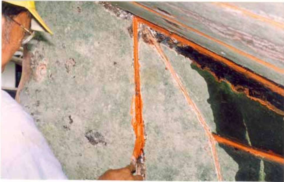
รูปที่ 52 การป้ายชั้นหน้าหมันไปบนแนวที่ซ่อมทำหลังจากล้วงหมันเนาออกแล้ว
