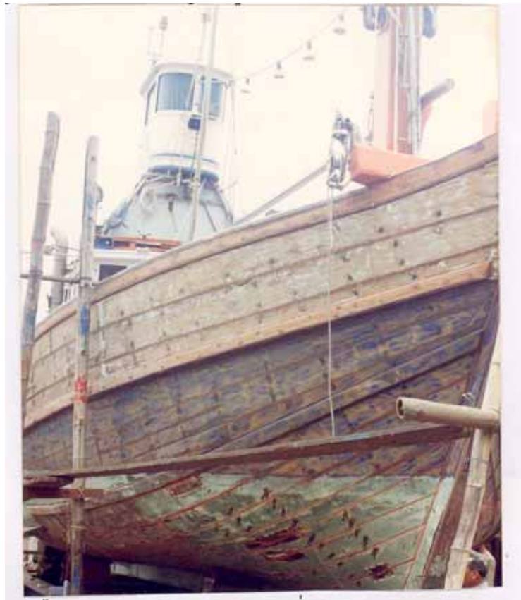
รูปที่ 82 เรือขนาดกลางเข้ารับการซ่อมทำที่ใช้หมันปานและชันยาแนว
