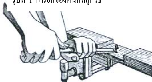
รูปที่ 3 เมื่อใช้มีดหรือสิ่วทำการตัดหรือบาก จะต้องให้ด้านคมหันออกจากตัวเสมอ
