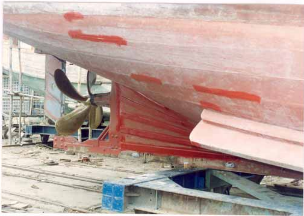
รูปที่ 85 เรือพร้อมที่จะลงน้ำหลังการตอกหมันและยาชันซ่อมแนว
