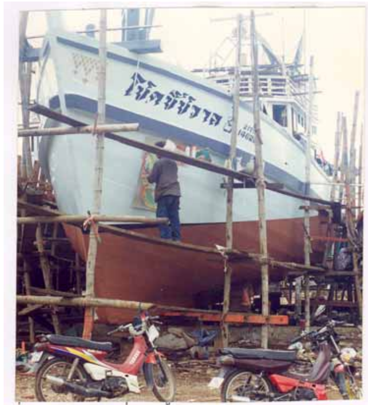
รูปที่ 84 เรือพร้อมที่จะลงน้ำหลังการตอกหมันและยาชันแนวซ่อม
