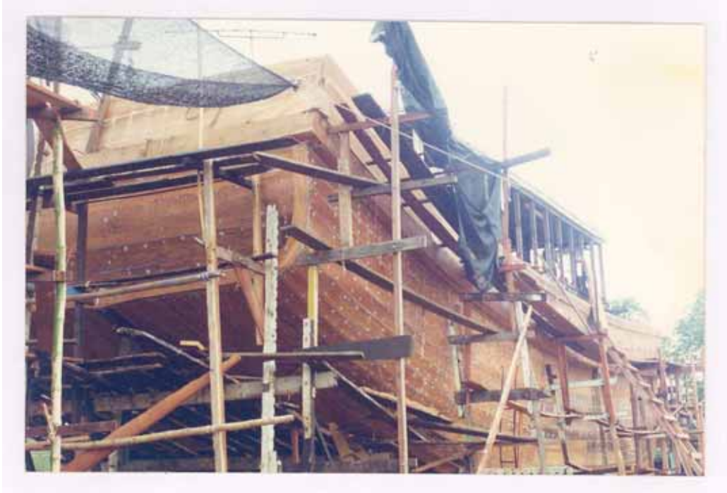
รูปที่ 81 เรือขนาดใหญ่ที่ใช้ปูนดำผสมน้ำมันตัวอ้วยาแนว
