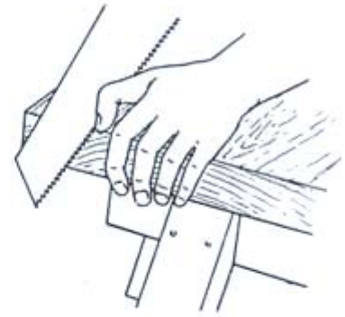
รูปที่ 2 จะต้องระมัดระวังเป็นพิเศษ ขณะใช้นิ้วหัวแม่มือควบคุมการเลื่อยไม้
